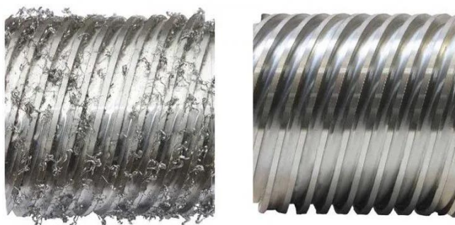
Рисунок 2 – Дефект заусенцы и обработанная деталь
