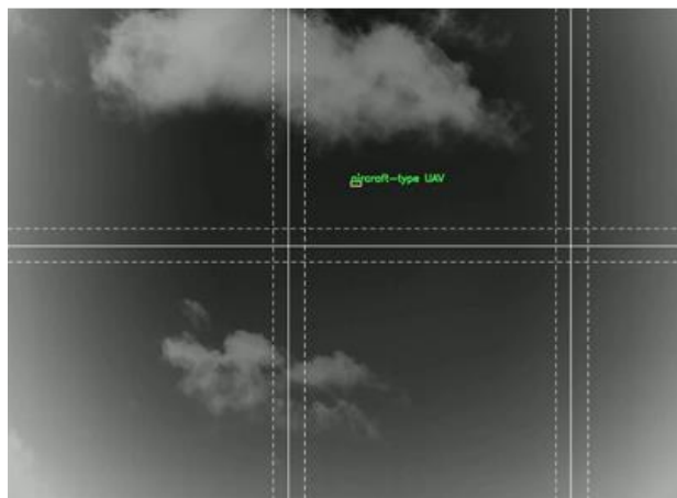
Рисунок 1 – Пример разделения кадра видеопотока на сегменты размером 512x512 с перекрытием 10% от размера сегмента
