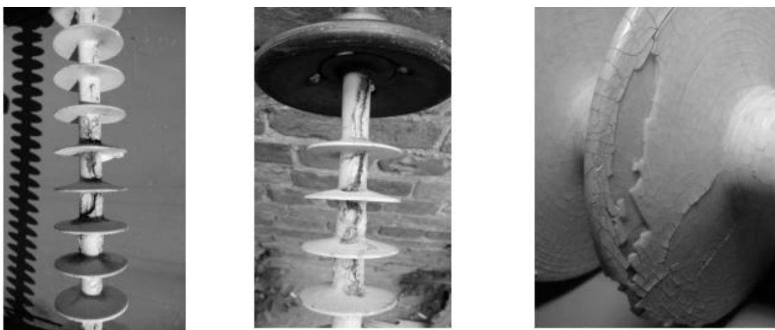
Рис. 2 Образование эрозии и трека на изоляторах I поколения
