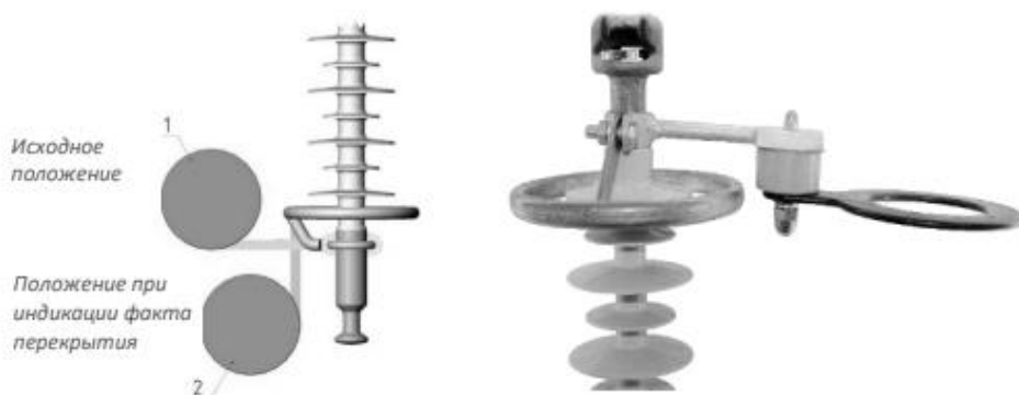
Рис. 3 Индикаторы перекрытия полимерных изоляторов
