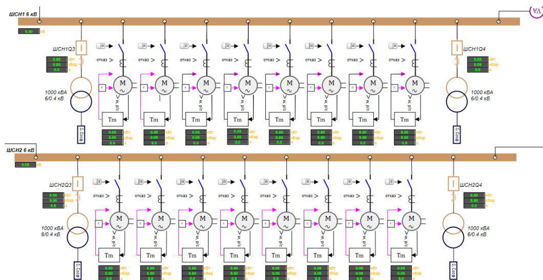
Рисунок 1. Схема электроснабжения собственных нужд.
