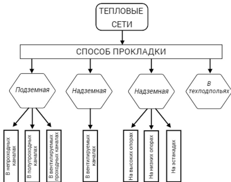
Рисунок 2. Варианты прокладки тепловых сетей
