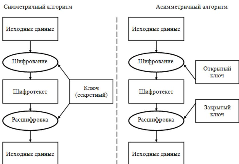
Рисунок 2 – Принципы работы симметричных и асимметричных алгоритмов шифрования
