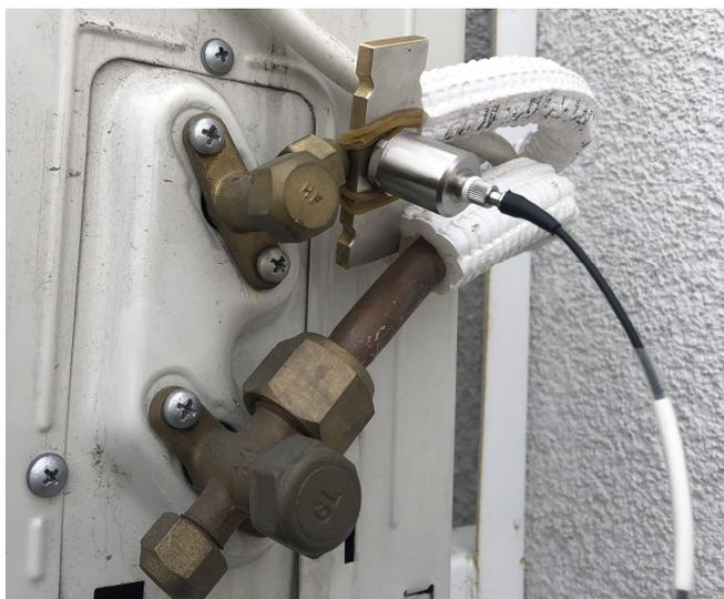
Рисунок 3 – Крепление акселерометра ПАК «Смарт», на внешнем блоке кондиционера ЗП
