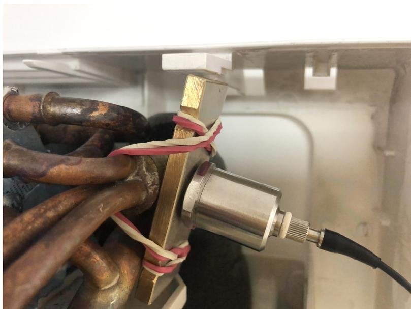
Рисунок 2 – Разработанное крепление для акселерометра на внутреннем блоке кондиционера
