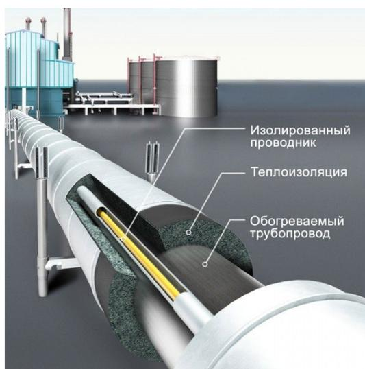
Рисунок 1 –Схема обогрева трубопровода
