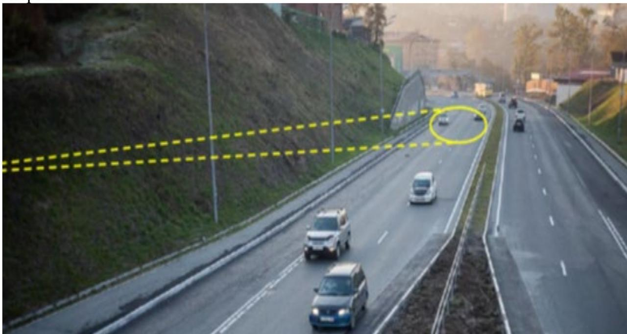
Рисунок 2 – Положение поля зрения узкопольной оптической системы обнаружителя транспортных средств на контрольном участке проезжей части
