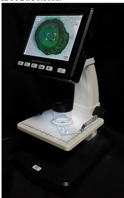
Рисунок 1 – Цифровой USB-микроскоп МИКМЕД LCD
