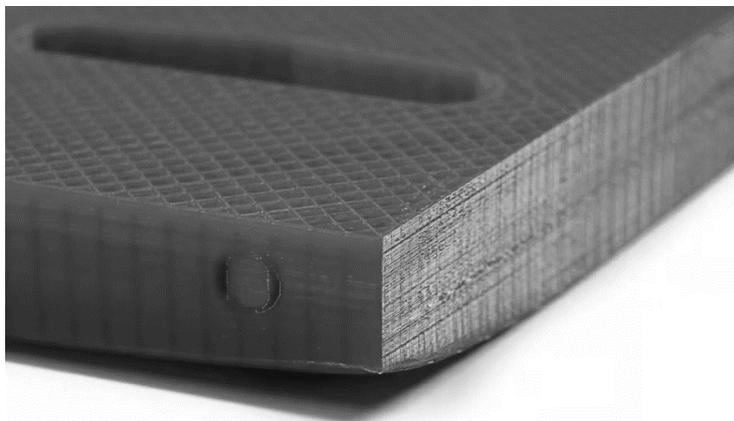
Рисунок 1 – Усадка детали в виде «отлипания» от стола
