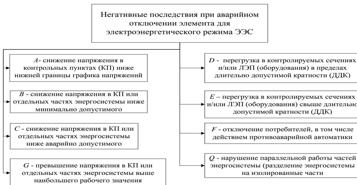
Рис. 1. Перечень возможных негативных последствий при аварийном отключении  $k$ -го элемента для электроэнергетического режима ЭЭС.
