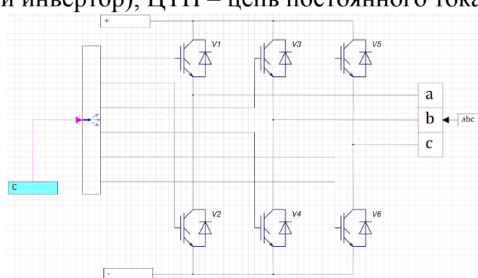
Рис. 4 – Модель инвертора, выполненная в программном комплексе SimInTech .
