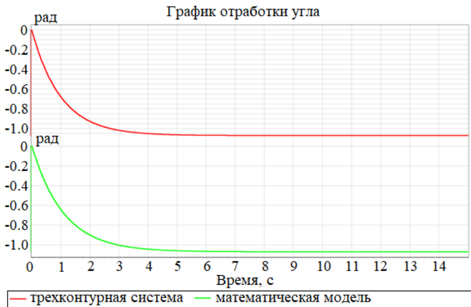
Рисунок 7 – Осциллограммы отработки угла в системе с нагрузкой 2 А
