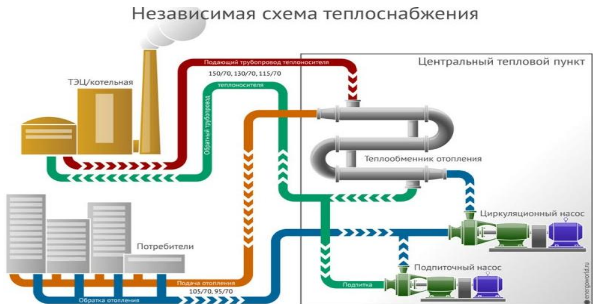
Рисунок 2- Независимая схема теплоснабжения
