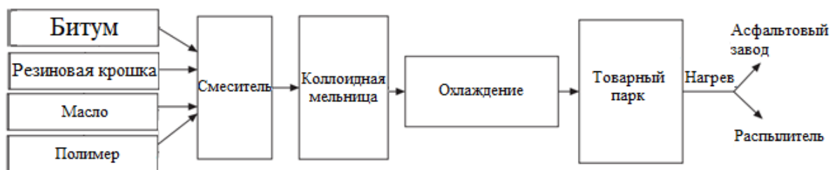
Рисунок 1 — Технологическая схема производства, не предназначенного для длительного хранения модифицированного битума
