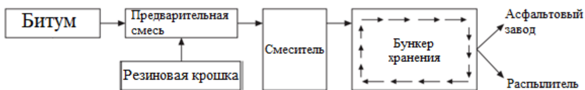
Рисунок 1 — Технологическая схема производства, не предназначенного для длительного хранения модифицированного битума
