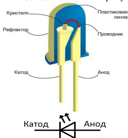
Рисунок 1 – Устройство излучающего диода
