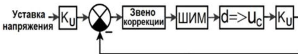
Рисунок 1 — Структурная схема замкнутой системы управления импульсного преобразователя напряжений с управлением по отклонению
