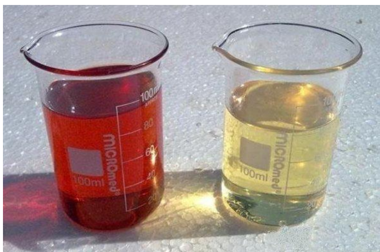
Рисунок 1 – Внешний вид отработанного (слева) и чистого (справа) трансформаторного масла
