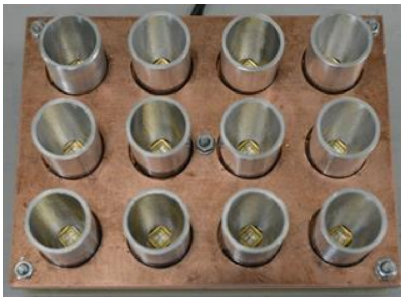
Рисунок 6 – Пример реализации источника оптического излучения с отражателями-радиаторами излучающих диодов
