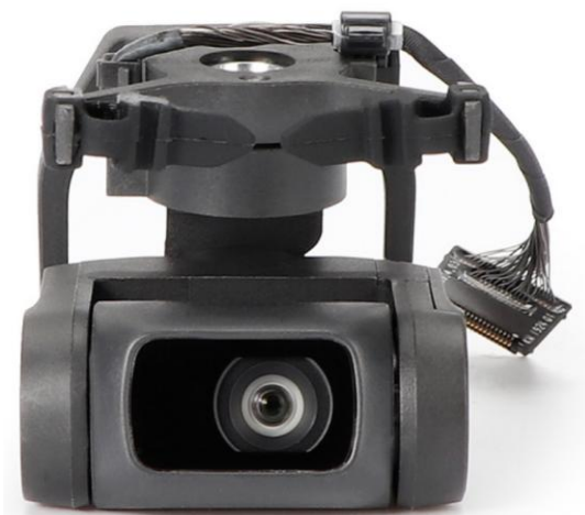
Рис. 2 Карданов подвес для камер
