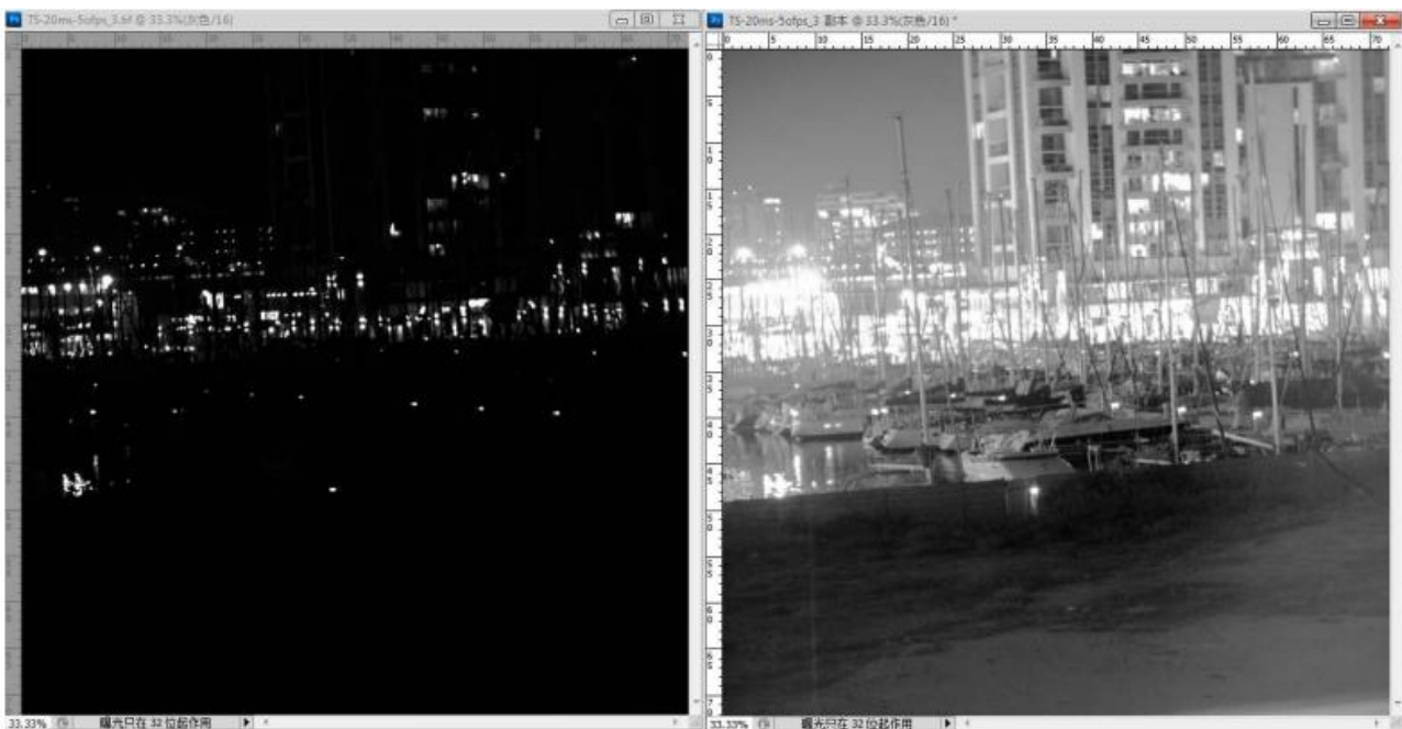
Рисунок 3 – Сравнение изображений при различной температуре сенсора
