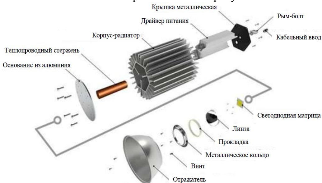
Рисунок 1 – Вариант конструктивного исполнения источника оптического излучения
