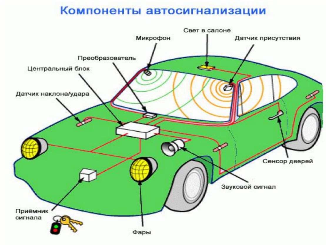
Рисунок 1 – Устройства, которые могут входить в состав автосигнализации и их локализация в автомобиле
