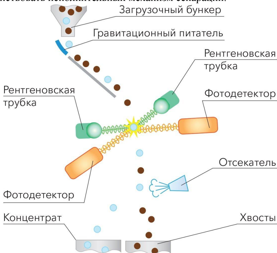
Рисунок 1 — Схема прибора для рентгенолюминесцентной сепарации
