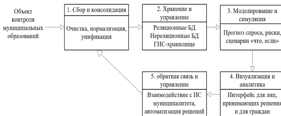
Рисунок 1 – Архитектура цифрового двойника муниципального образования
