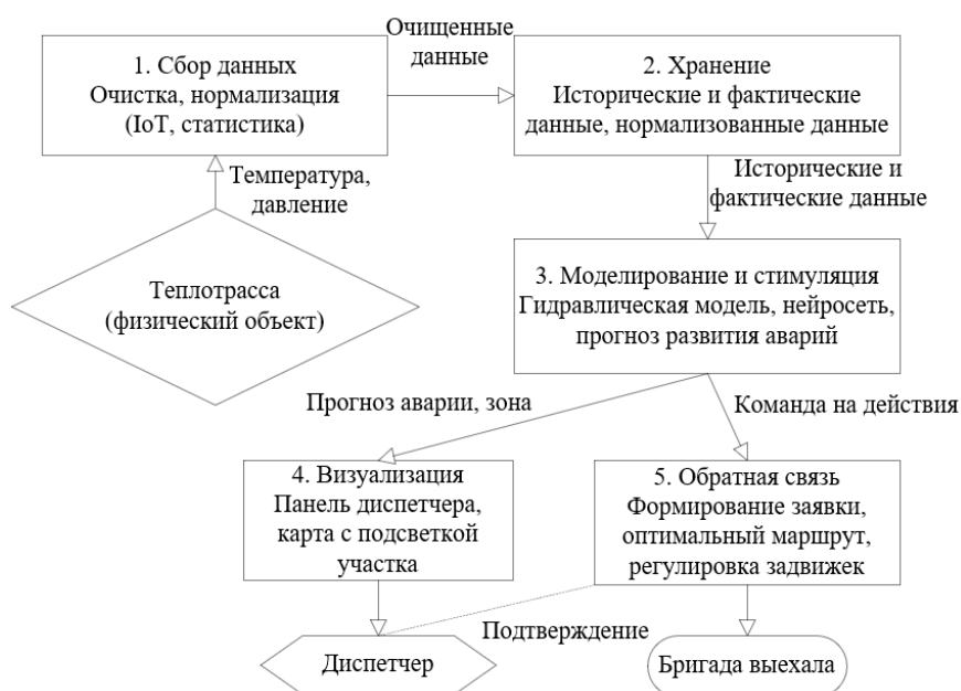
Рисунок 2 – Диаграмма потоков данных при прогнозировании аварии
