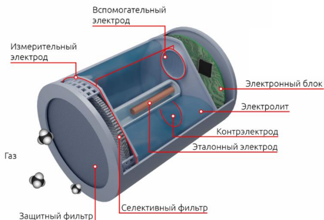
Рисунок 2 – Принцип работы электрохимического газового сенсора
