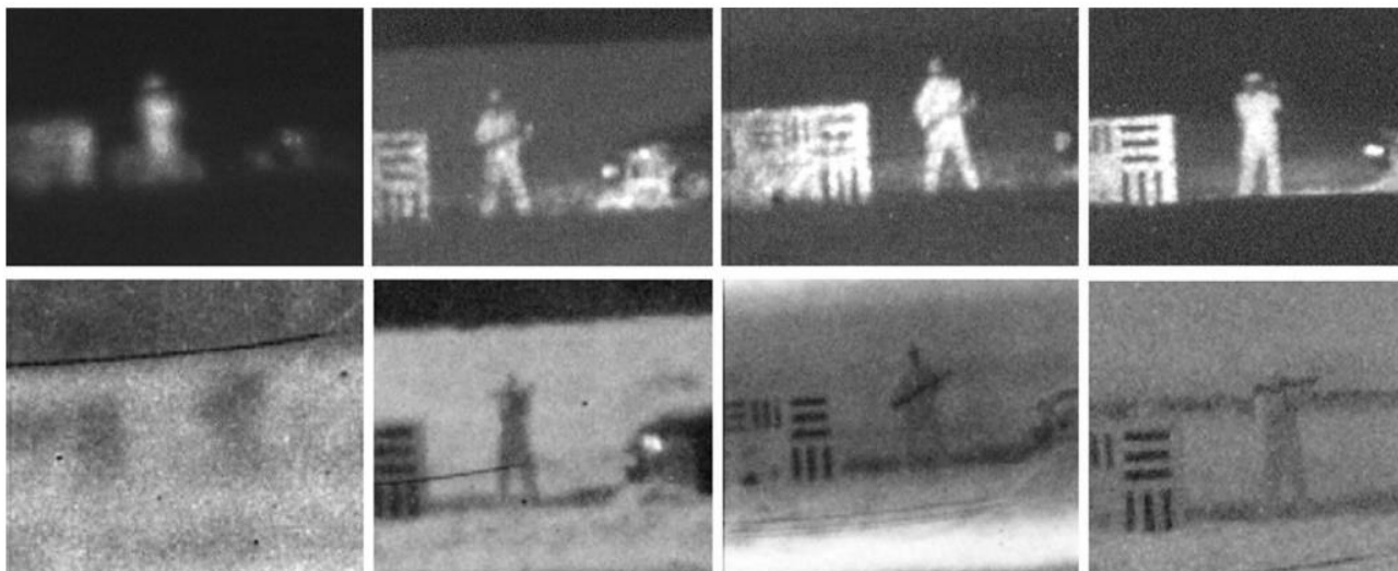
Рисунок 1 – Сравнение активных(вверху) и пассивных(внизу) SWIR-изображений человека на дальности 2 км при различных высотах расположения сенсора (1,6; 5,15; 7,65 и 10,35 м)
