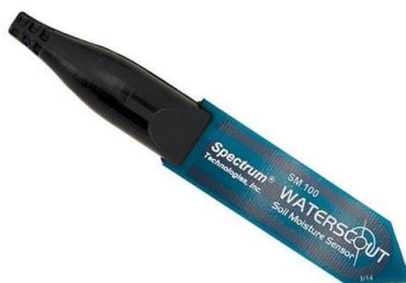
Рисунок 3 – Профессиональный ёмкостной датчик WaterScout SM10
