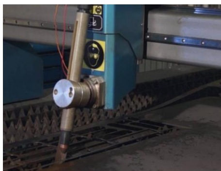
Рисунок 2 – Столкновение резака с деталью
