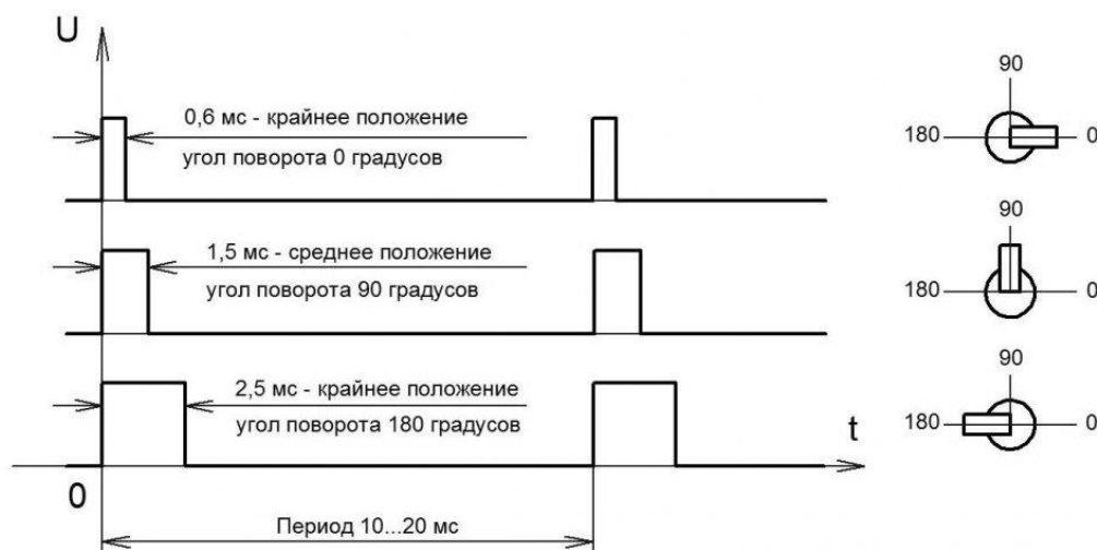
Рисунок 8 – Принцип работы сервомотора
