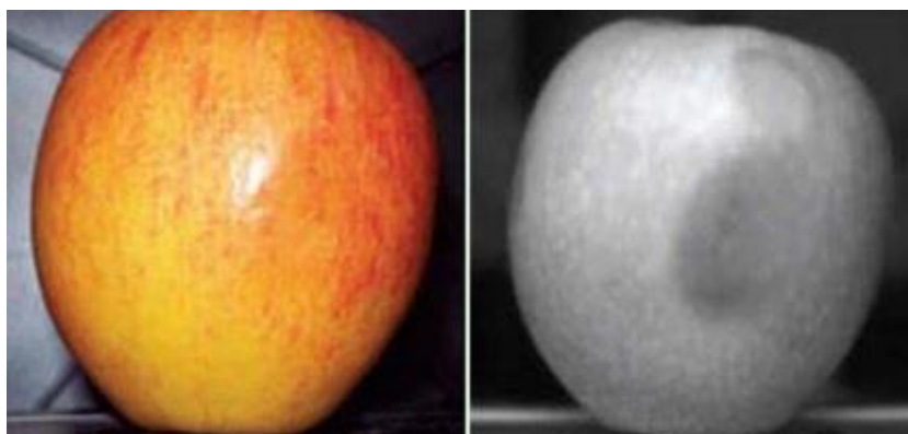
Рисунок 3 – Визуализация объектов в условиях отсутствия естественного освещения с применением SWIR -сенсора и активной импульсной подсветки
