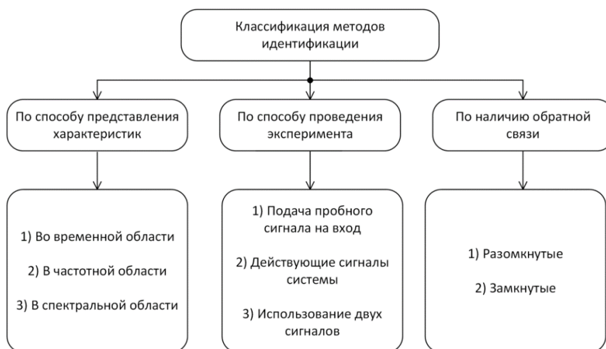
Рисунок 3 – Классификация методов идентификации параметров для реализации адаптивных систем управления
