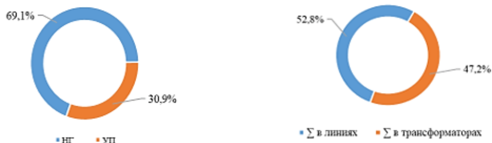
Суммарные нагрузочные потери электроэнергии в сети, \Sigma \Delta W Суммарные условно-постоянные потери электроэнергии в сети, \Sigma \Delta W
